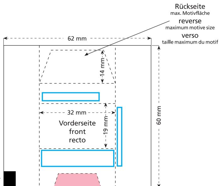
Bedruckbare Fläche · printing surface · surface d'impression
