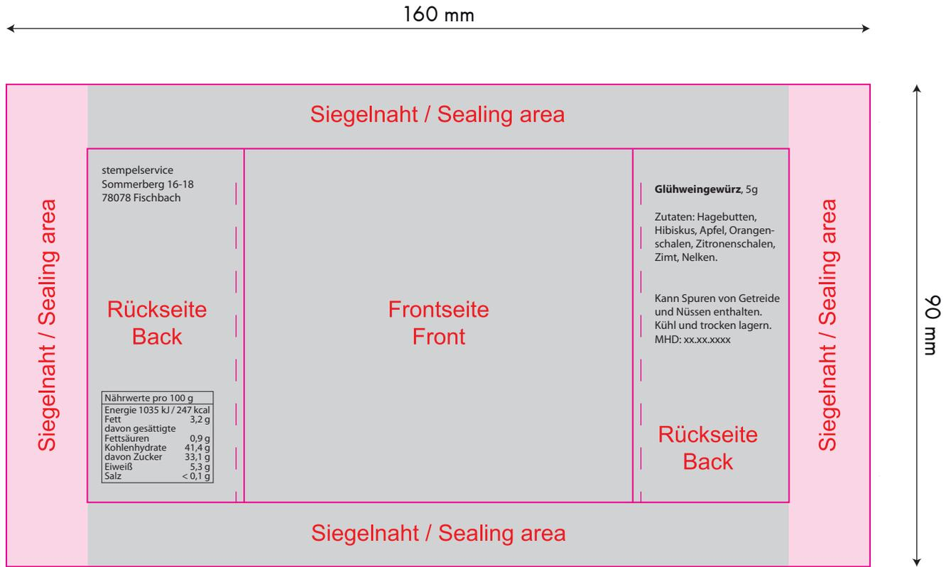
Siegelnaht ist bedruckbar mit einer Farbe oder einem Hintergrundbild.
